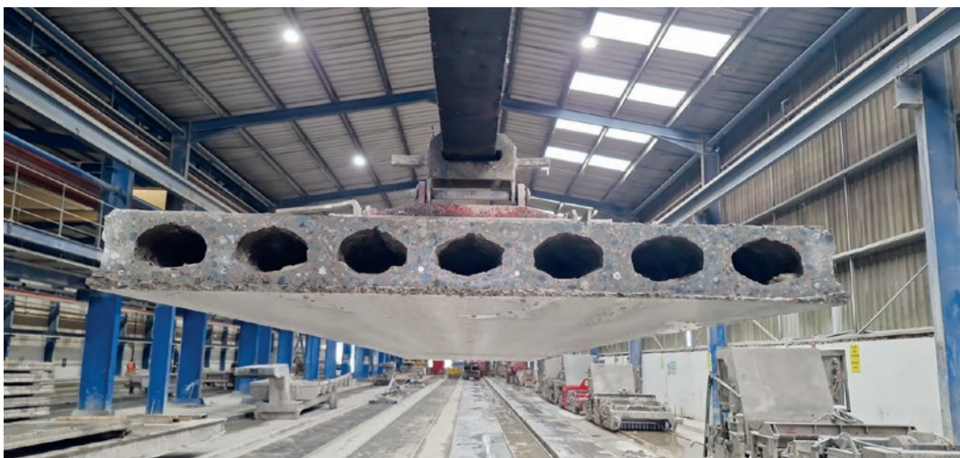
Placa alveolar pretensada con 7 alveolos, fabricada con la extrusora EVO2 de Nordimpianti
